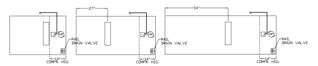
WRAPPED REFRIG. RECESSED MEGA PAN RAIL W/DRAIN & S/S HINGED SLIDE BACK COVERS (PANS BY OTHERS)
