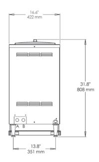
A 5/8" SUCTION LINE QUICK DISCONNECT B 3/8" LIQUID LINE QUICK DISCONNECT
