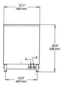
A 5/8" SUCTION LINE QUICK DISCONNECT B 3/8" LIQUID LINE QUICK DISCONNECT
